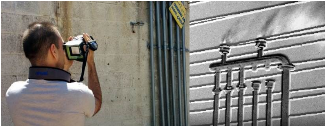
בתמונות: מצד שמאל הפעלת מצלמה תרמית, מצד ימין תמונה המתקבלת ממצלמה תרמית
